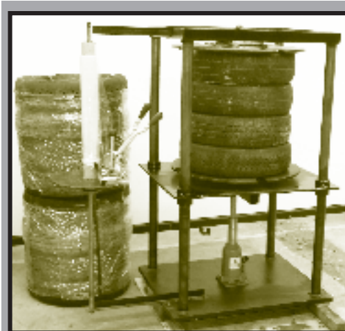
Máquina con la que se fabrican los conductos
